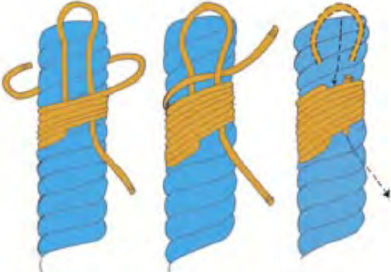
4a: Eine Schlinge (Bucht) der Länge nach an das Tau legen und Tau und Schlinge von unten nach oben stramm umwickeln
