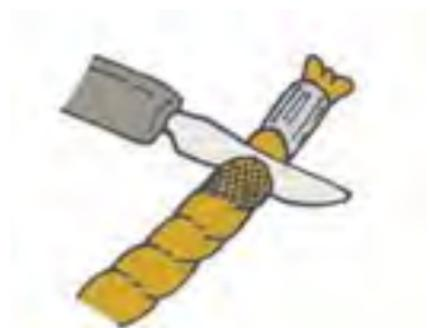
Abb. 3c: An der verschmolzenen, abgekühlten Stelle durchschneiden
