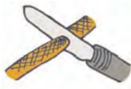
Abb. 2b: An der abgekühlten, verschmolzenen Stelle abschneiden
